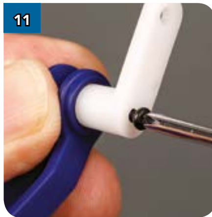
11 Скрепите детали саморезом 2,3 x 6 мм.
