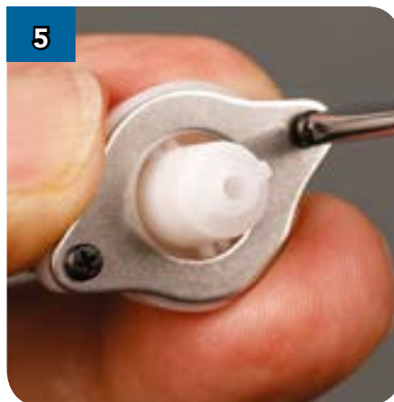
5 ...и двумя саморезами 2 x 6 мм прикрепите её к детали (BF-47).
