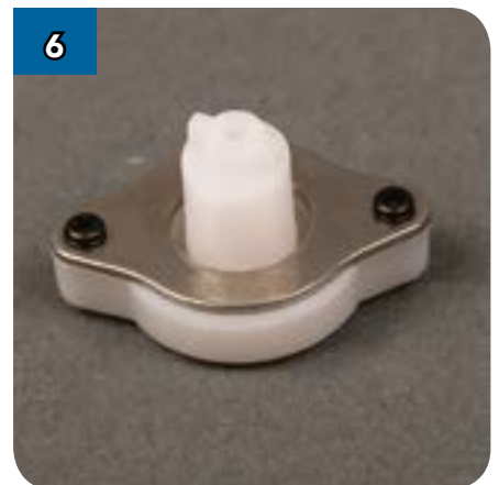
6 Ваше готовое сцепление должно выглядеть так, как показано на фотографии.
